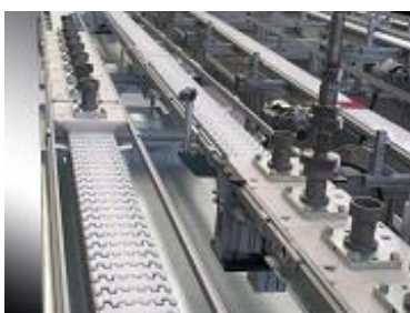
Palettentransport zur Bestückung Montageautomat
