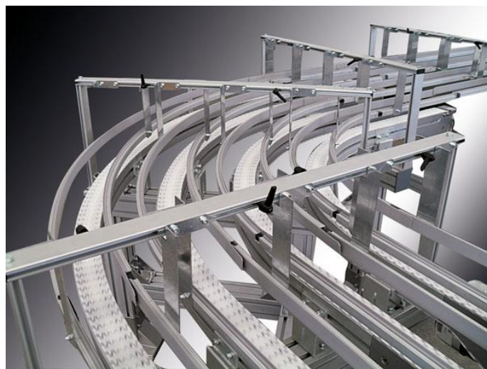
Abbildung zeigt 4-bahnigen Kurventransport für Toilettenpapier
