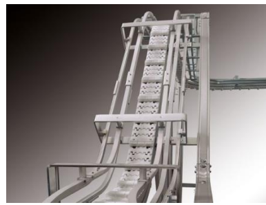
Transportband mit vertikalen und horizontalen Kurven für Faltschachteln
